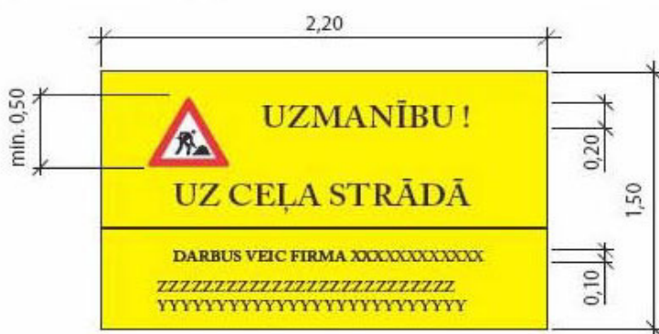
2. attēls – būvdarbu gaitā izmantojamie pagaidu satiksmes organizācijas līdzekļi (zīmējumu numuri atbilstoši MK noteikumiem Nr. 421 „Noteikumi par darba vietu aprīkošanu uz ceļiem”)
