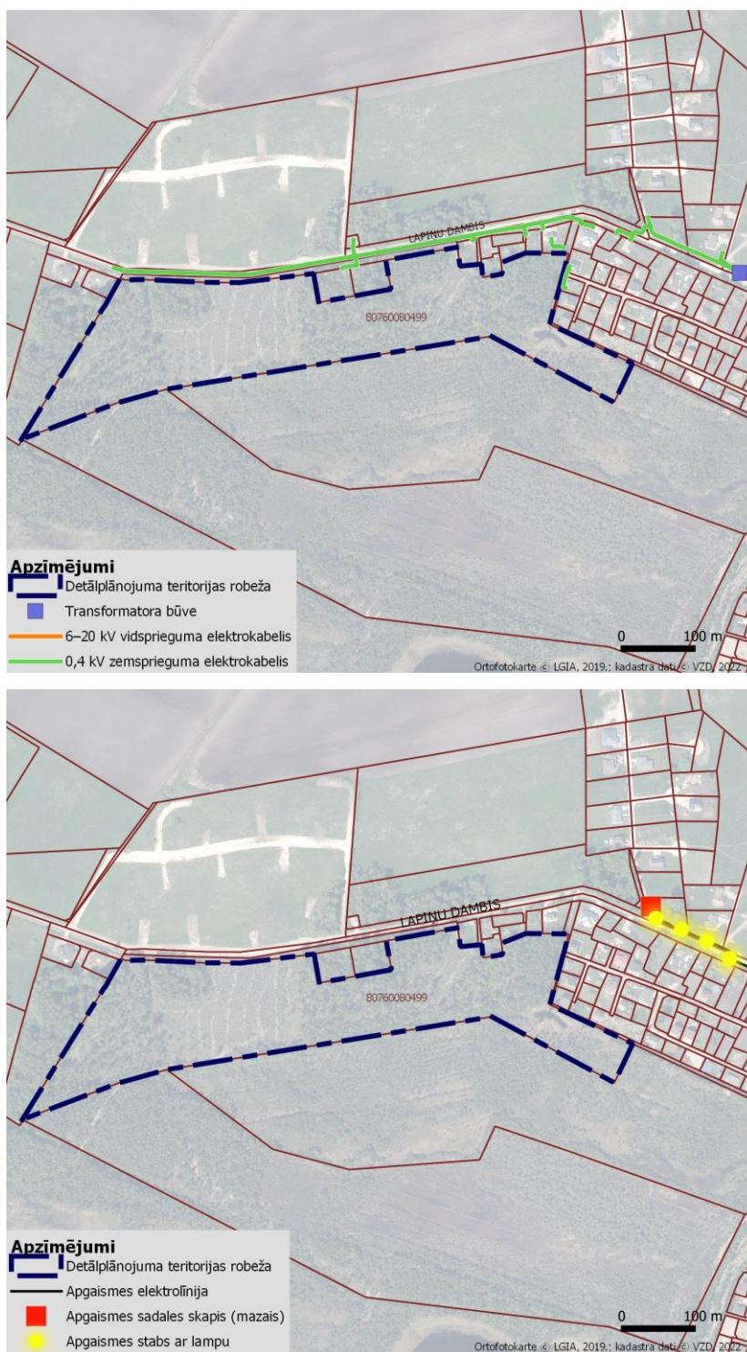
15., 16. attēls. Esošās elektroapgādes shēma un esošais ielas apgaismojums
