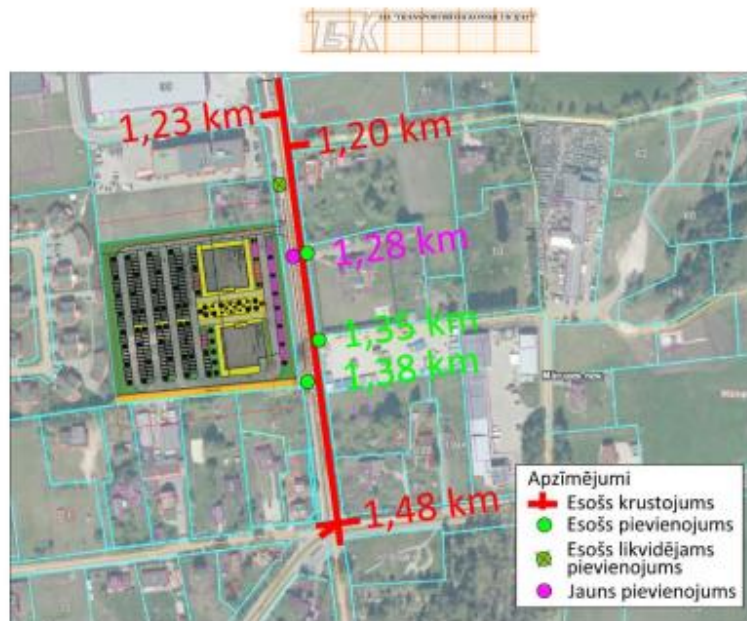
2.att. Pievienojumu izvietojums autoceļa V16 posmā.
