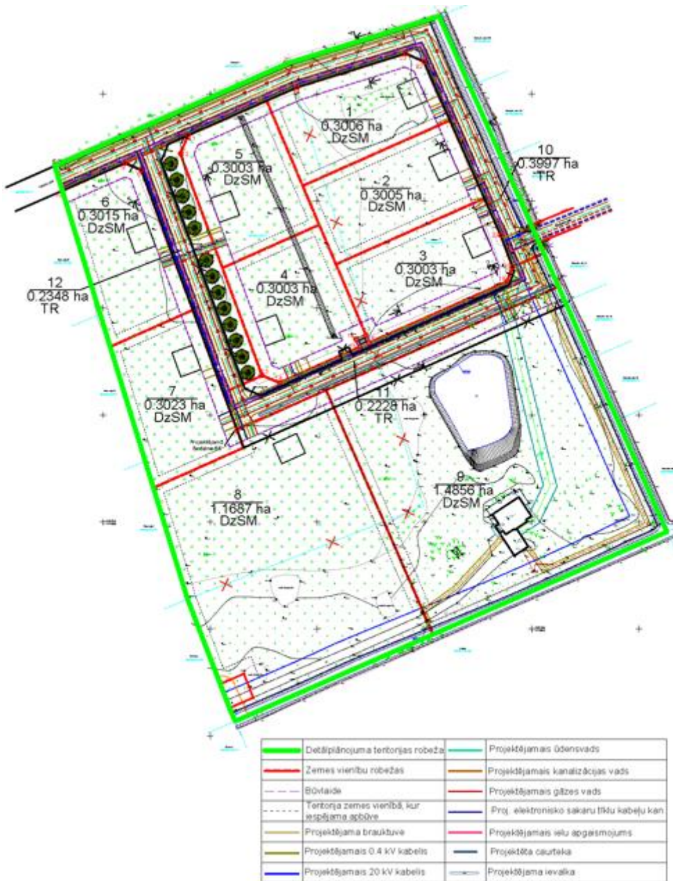
Attēls Nr. 12. Inženierkomunikāciju nodrošinājums (Precizēts ar Detālplānojuma grozījumiem 10.2021)
