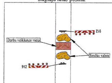
Būvdarbu vietas lokālais aprikojums caurbraukšanai slēgtajā ielas posmā.
