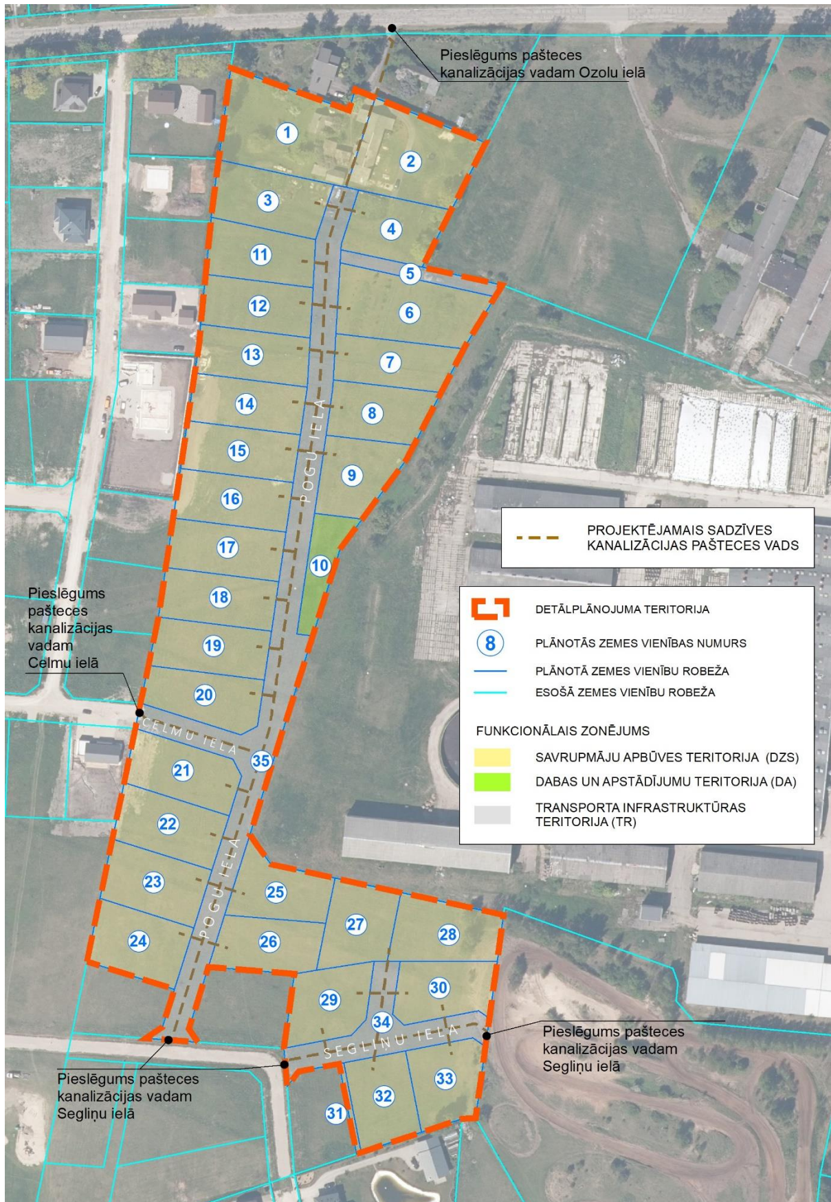
16. att. Sadzīves kanalizācijas novades shēma
