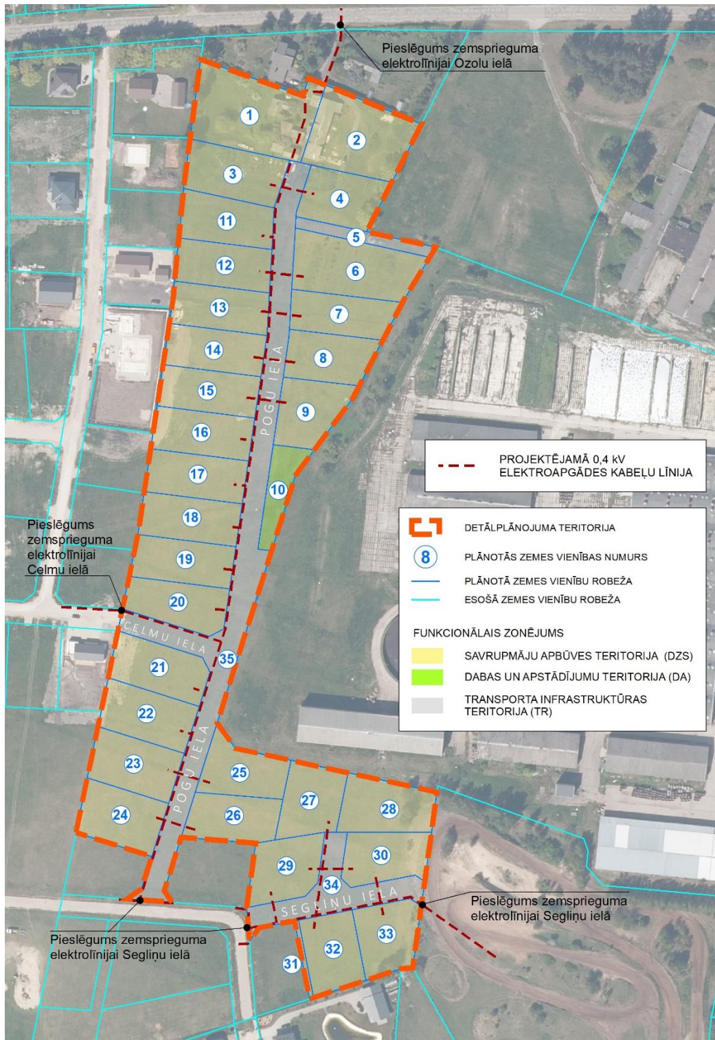
14. att. Elektroapgādes shēma
