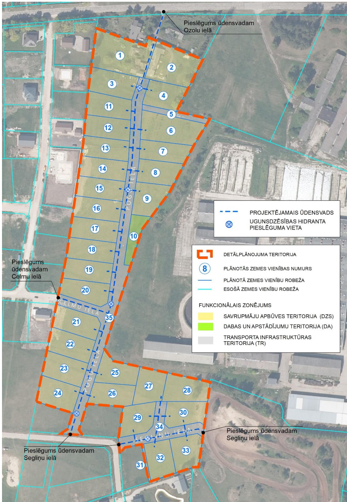
15. att. Ūdensapgādes shēma
