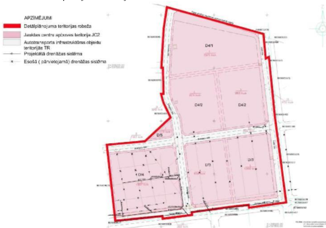
4.att. 2014.gada detālpānojuma risinājums ielu struktūras, zemesgabalu sadales un drenāžas sistēmas pārkārtošanai detālpānojuma teritorijā.
