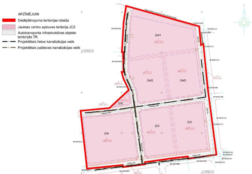
Attēls Nr.32. Saimnieciskā kanalizācija un lietus kanalizācija
